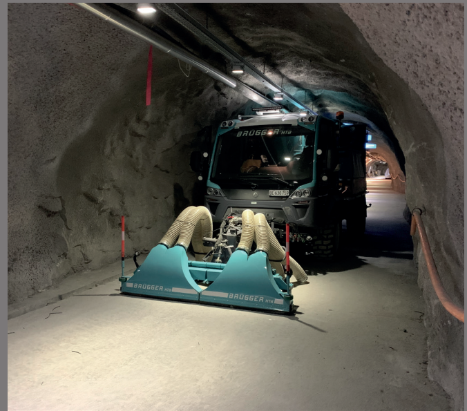
Foto: Reinigungsmaschine für enge Tunnelkavernen
