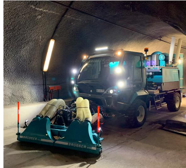
Die Reinigung erfolgte ausschliesslich im Trockenverfahren. Das Schienenbett wurde mit dem von Brügger HTB entwickelten und patentierten Saug-Vorblasssystem gereinigt. Die Reinigungsgeräte für den Bahntunnel und Nebenbauwerke wurden im Betrieb laufend ergänzt und verbessert.
